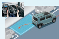
スマートパノラマパーキングアシスト (駐車支援システム) 動作イメージ
